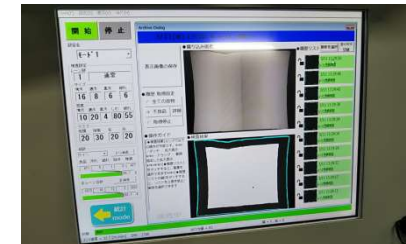
4.異物付着自動検査モニター
