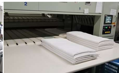
3.高温によるプレス工程機
